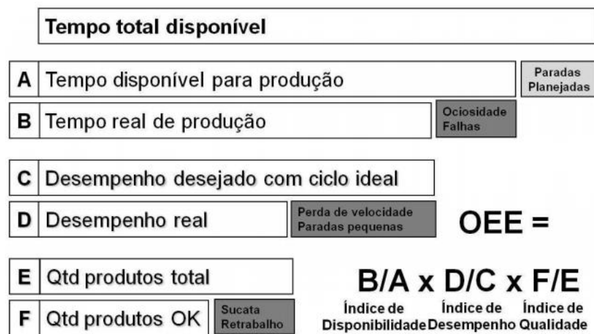
Figura 11 - Estratificação das categorias de utilização de tempo no funcionamento de uma produção par ao cálculo de OEE
